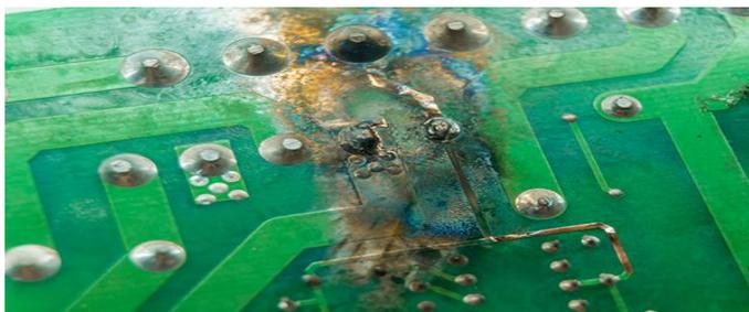
接触短路、零件损坏和错误布线等
