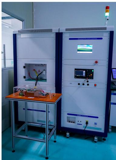
雷电波形试验设备
